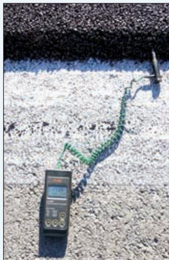
Figura 20 - La misura delle temperature del drenante
