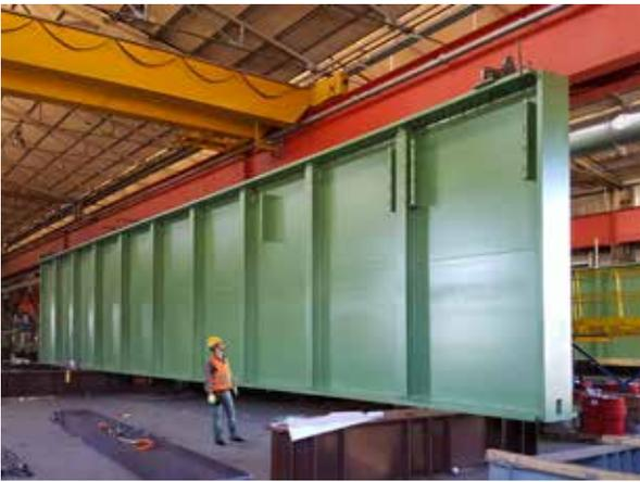
Procedimenti di saldatura qualificati per giunzioni a piena penetrazione tra anime e piattabande con spessori fusi fino a 60 mm e giunzioni testa a testa fino a 150 mm garantiscono, insieme al contributo di operatori certificati secondo le normative EN/AWS/ASME, l'eccellenza del prodotto in conformità agli standard internazionali.
